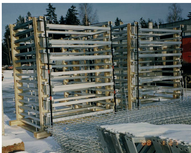
Figur. 3. Profiljern og konstruktioner lagres med hældning og vendes således, at vandsamlinger undgås. Der placeres mellemlæg, så der ikke opstår spalter og således at alle flader ventileres.
