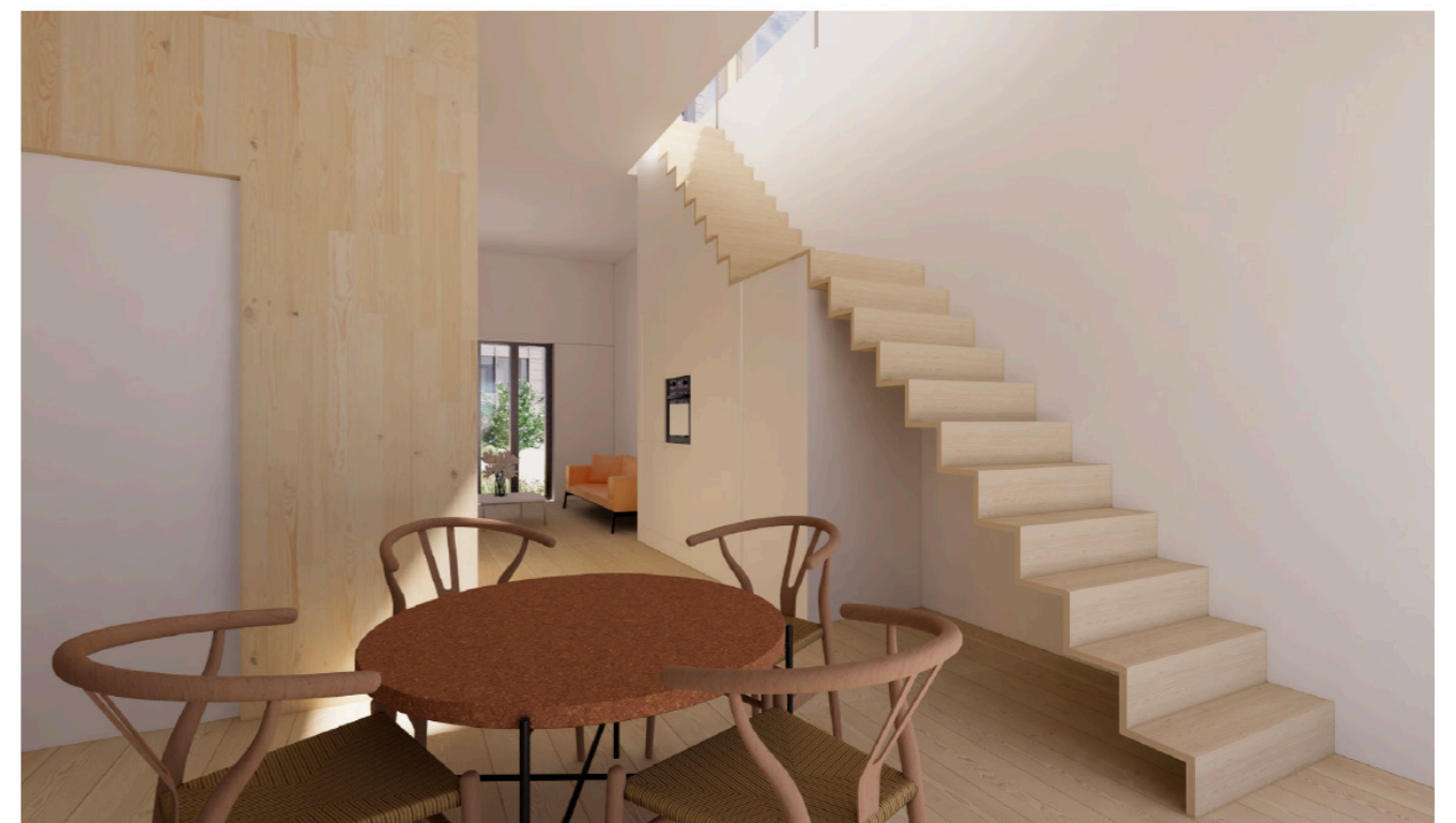
Trappen i de to boliger, som har højest til loftet. For ikke at gøre trappen for massiv, er den sidste del opført som "åben". Der kan evt. integreres inventar, der knytter sig til køkkenet.
